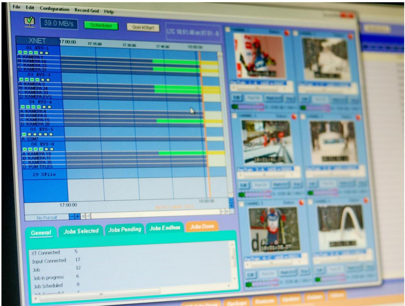
Рис 3. Видеоархив соревнования формировался станцией EVS XFile, записывающей все входные каналы серверов видеоповторов EVS XT/XT2/XT3, что в общей сложности составило от 6-ти до 30-тих видеопотоков реального времени.
